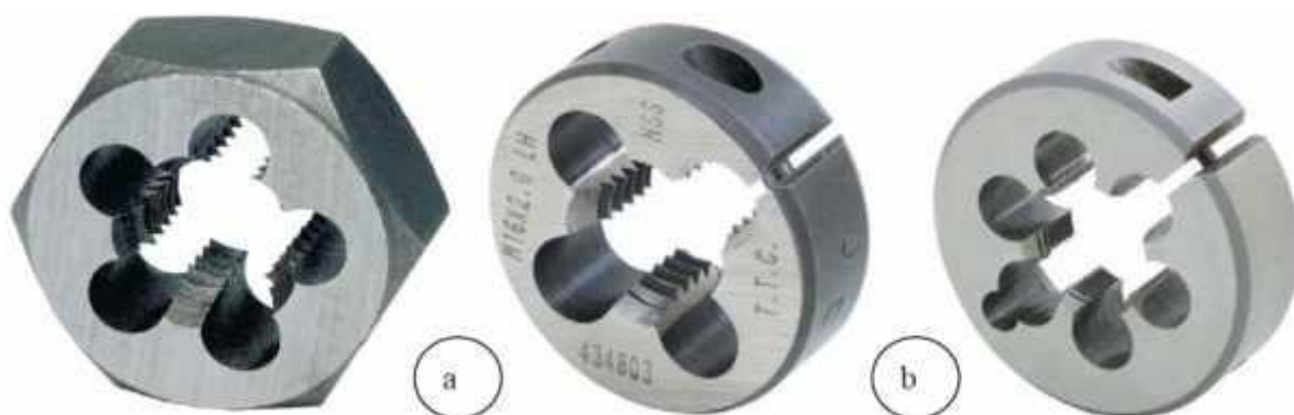
Fig.1.57.Filiera (a-filieră hexagonală; b-filieră rotundă)
