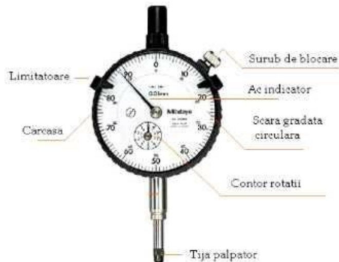
Fig.5.10. Părți componente ceas comparator
