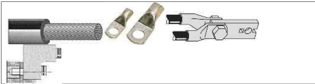
Fig. 2.49. Modalități de realizare a conexiunilor cu ajutorul papucilor
