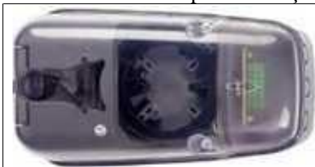
Fig. 8.30. Detector de fum cu senzor fotoelectric. Detectorul de fum cu senzor fotoelectric funcționează pe baza principiului fotoelectric. Detectorul este prevăzut cu LED pentru indicarea funcționalității și alarmă sonoră. Detecția cu senzor fotoelectric reduce numărul alarmelor false, cum ar fi cele cauzate de fumul gătitului sau aburul dușului
