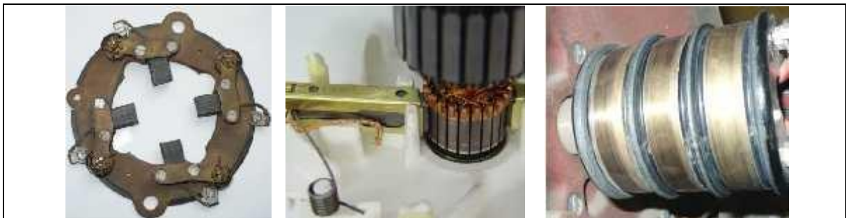
Fig. 2.25. Port – perii, perie – colector, inele colectoare ale mașinilor electrice.
