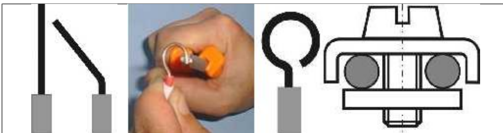
Fig. 2.46. Tehnologia de realizare a ochiului pentru conectare
