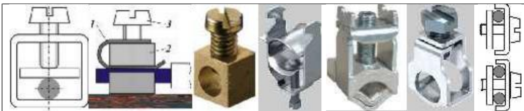
Fig. 2.45. Fixarea conductoarelor în terminalele aparatelor electrice
