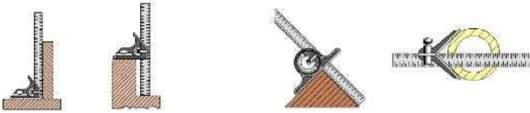
Fig. 1.22. Controlul abaterilor la trasare
