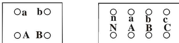
Figura 2.18. Disponerea și marcarea bornelor la transformatoare
